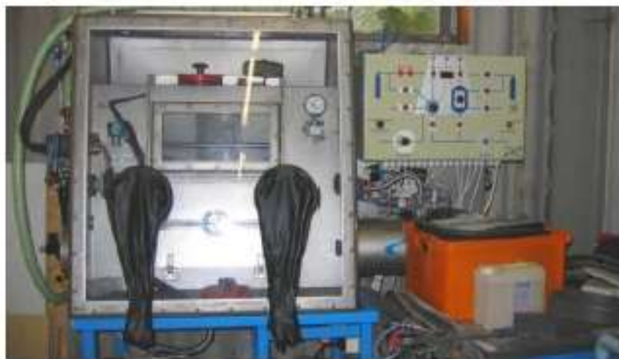
Aufgrund der Toxizität von Berylliumstaub müssen mit diesem Leichtmetall befüllte Probenzylinder in einer der sieben sogenannten Glovebox verschlossen werden. (Bild: GVT)
